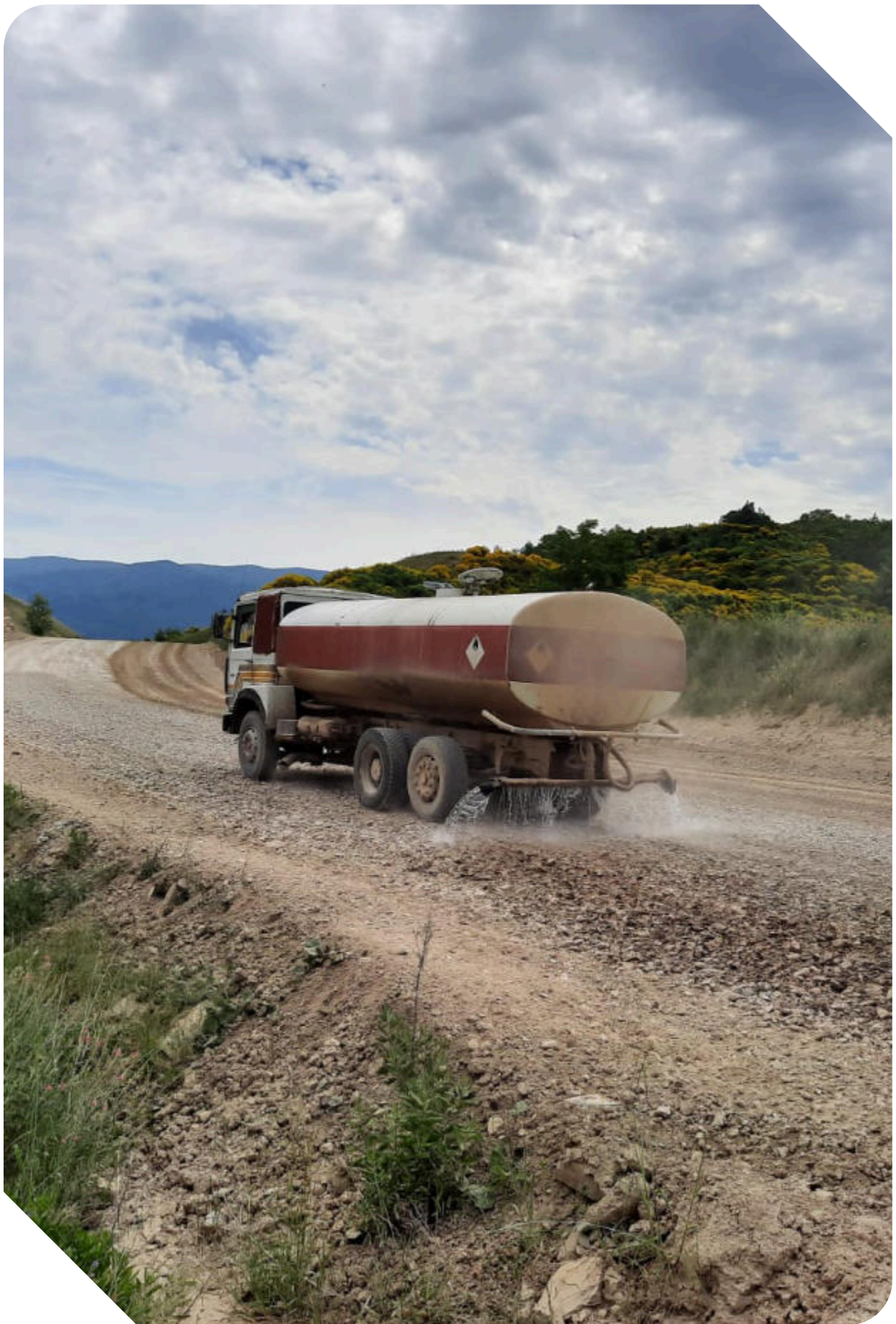
Camion con sistema di abbattimento polvere lungo le strade interne alla miniera Begliano (AR). E' un metodo semplice utilizzato in molte attività estrattive (camion con botte, o cisterna/cassone del camion e irrigatori in uscita).
